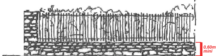
MURET SURMONTÉ D'UN DISPOSITIF À CLAIRE-VOIE (DOUBLÉ D'UNE HAIE)
