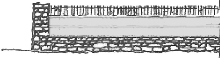
MURET SURMONTÉ D'UN DISPOSITIF OPAQUE (PAROI PLEINE)
