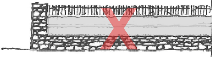
MURET SURMONTÉ D'UN DISPOSITIF OPAQUE (PAROI PLEINE)
