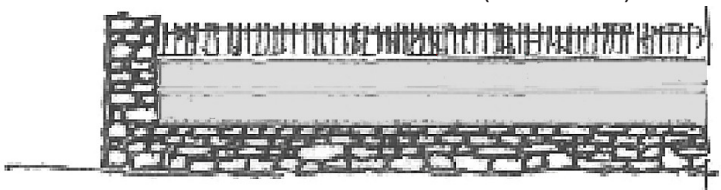
MURET SURMONTÉ D'UN DISPOSITIF OPAQUE (PAROI PLEINE)
