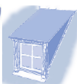
Lucarne rampante à versant plat ou Chien couché
